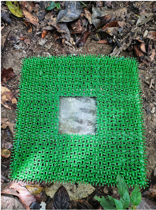
Image 4: deuxième version du piège à poil pour conserver au maximum l'attractant
